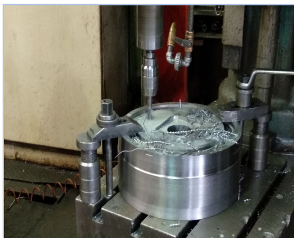
شکل ۳-۸- تراش و سوراخ‌کاری گرده
