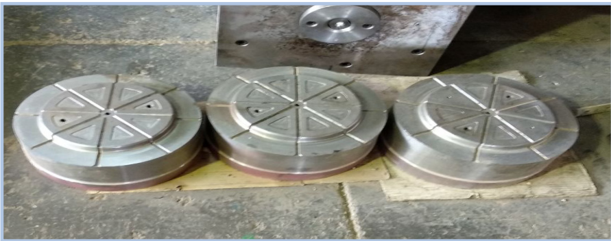
شکل ۳-۱۱- مسیره‌های عبور ماده مذاب در قالب
