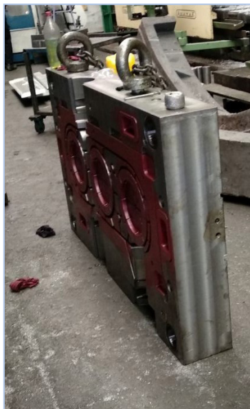
شکل ۳-۱۵- طرف core قالب در حالت مونتاز کامل
