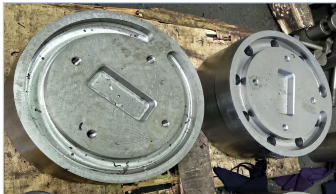
شکل ۳-۱۲- گرده‌ها در مرحله سوراخ‌کاری برای ایجاد راه‌آب. (در یک گرده سوراخ‌ها به‌طور کامل ایجاد شده. جای پیچ‌های اتصال نیز قابل‌دیدن است.)
